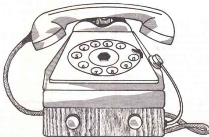
Fig. 1 - Principio di funzionamento del dispositivo descritto. Dalla parte frontale sporgono le due manopole per l'accensione e per la regolazione del volume. L'altoparlante è invece rivolto verso il retro, per cui non risulta visibile.
